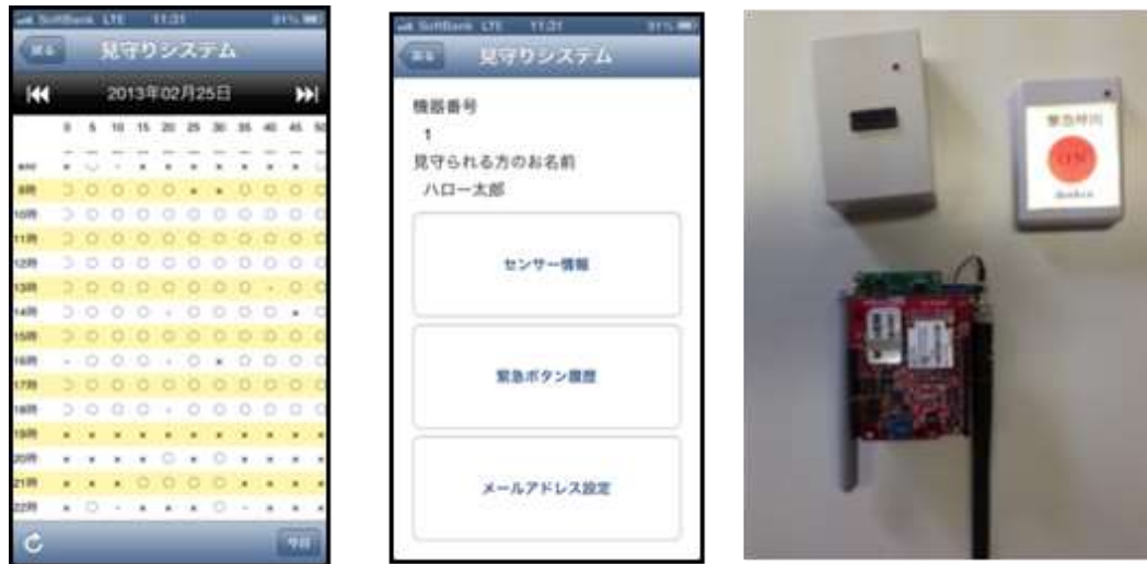
図6. 3G シールドを使った独居高齢者見守りシステム試作品
