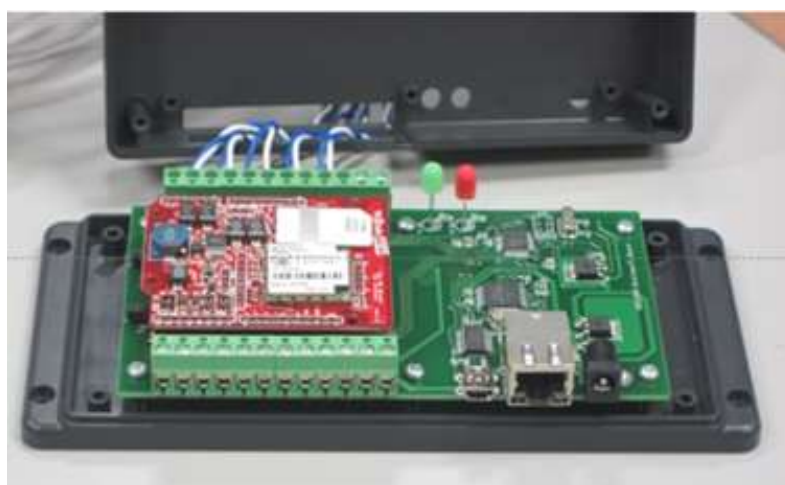
図 5. IEEE1888 を使った電力の見える化システム
