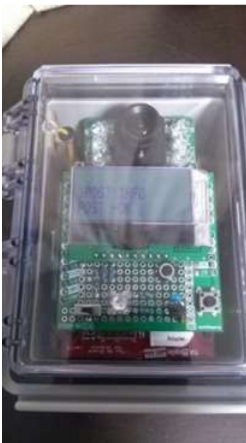
図4. 農業用観測システムの事例
