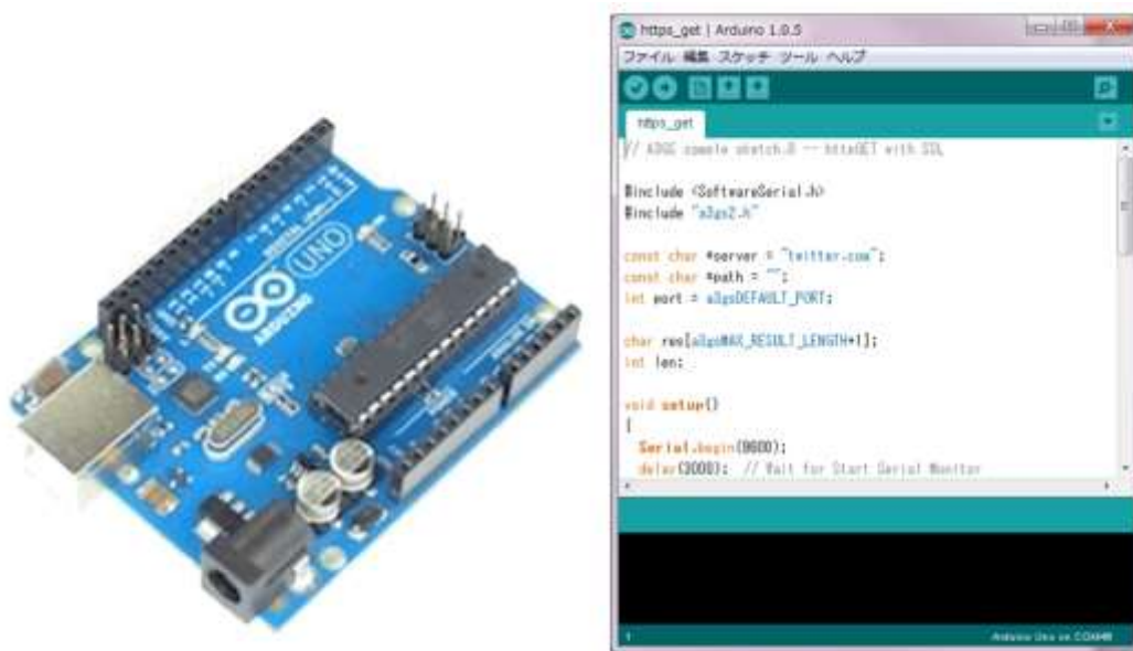
図 1. Arduino とはマイコンボード（左）と統合開発環境（右）
