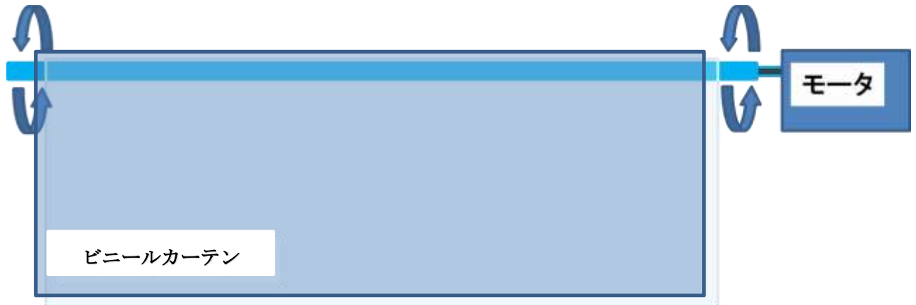
Fig.8 カーテン巻き上げ、巻き下げ機構の動作図
